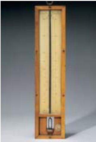
Quecksilberthermometer nach Réaumur, 1780: Die ältesten instrumentellen Messreihen setzen in der zweiten Hälfte des 17. Jahrhunderts ein. Ab der zweiten Hälfte des 18. Jahrhunderts verbreiteten sich meteorologische Messinstrumente rasch. Dieses 1780 in Mannheim konstruierte Thermometer ist nach dem französischen Physiker René-Antoine Réaumur skaliert: Wasser gefriert bei Null Grad und siedet bei 80 Grad. Die heutige Celsius-Skala gilt in Deutschland seit 1924.
